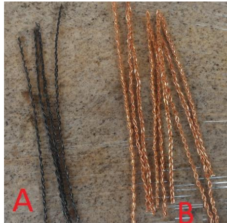
FIGURA 2 - Fibra de arame de aço recozido (A) e fibra de cobre eletrolítico (B)
